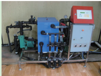
〈그림 2-43〉 양액 제어 시스템(연속혼합식)의 예
